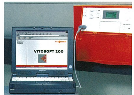
VITOSOFT200及Optolink電腦介面、簡化鍋爐設備的點火、保養和維修服務。
